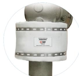
El Protector contra Fuego FIRESAFE® es fabricado con una composición múltiple de tejidos técnicos combinados con diferentes propiedades específicas, formando una barrera protectora que evita la exposición directa del fuego de un posible incendio en los tornillos de las válvulas de Wafers, evitando la dilatación de los tornillos y las fugas de fluidos para el medio ambiente, lo que alimentaría la combustión.
