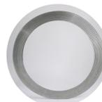
Una alternativa para presiones de trabajo elevadas es el uso de las juntas metálicas macizas (tipo diente de sierra). La forma dentada (tipo diente de sierra) permite un mejor aplastamiento y crea un efecto de laberinto en la superficie de sellado. Al mismo tiempo que posee una característica deseable del punto de vista de sellado, el dentado puede provocar riesgos en las bridas. En virtud de eso y combinando
