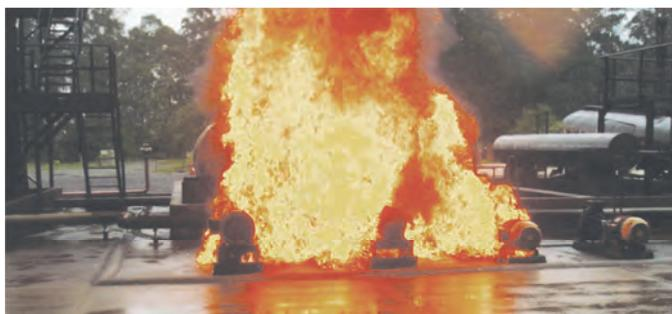
Los protectores fueron sometidos a simulación de condiciones reales de incendio en planta Petroquímica.
