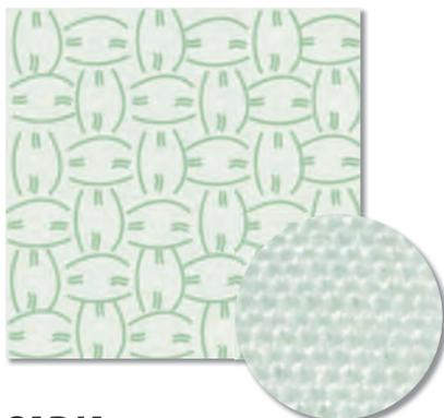
Los tejidos fabricados en el estampado tipo Tela poseen mayor estabilidad dimensional por el hecho de tener un número elevado de puntos de conexión entre trama y urdimbre, siendo por lo tanto utilizados en aplicaciones donde se necesita resistencia a la apertura del tejido (ejemplo: guantes, delantales y paneles balísticos).
