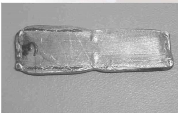
Figura 7 – Ruptura da camisa de aço carbono
