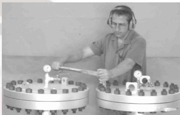
Figura 8 – Dispositivos de teste de selabilidade
