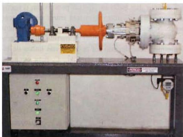
Figura 9 – Bancada de testes: válvula de bloqueio
